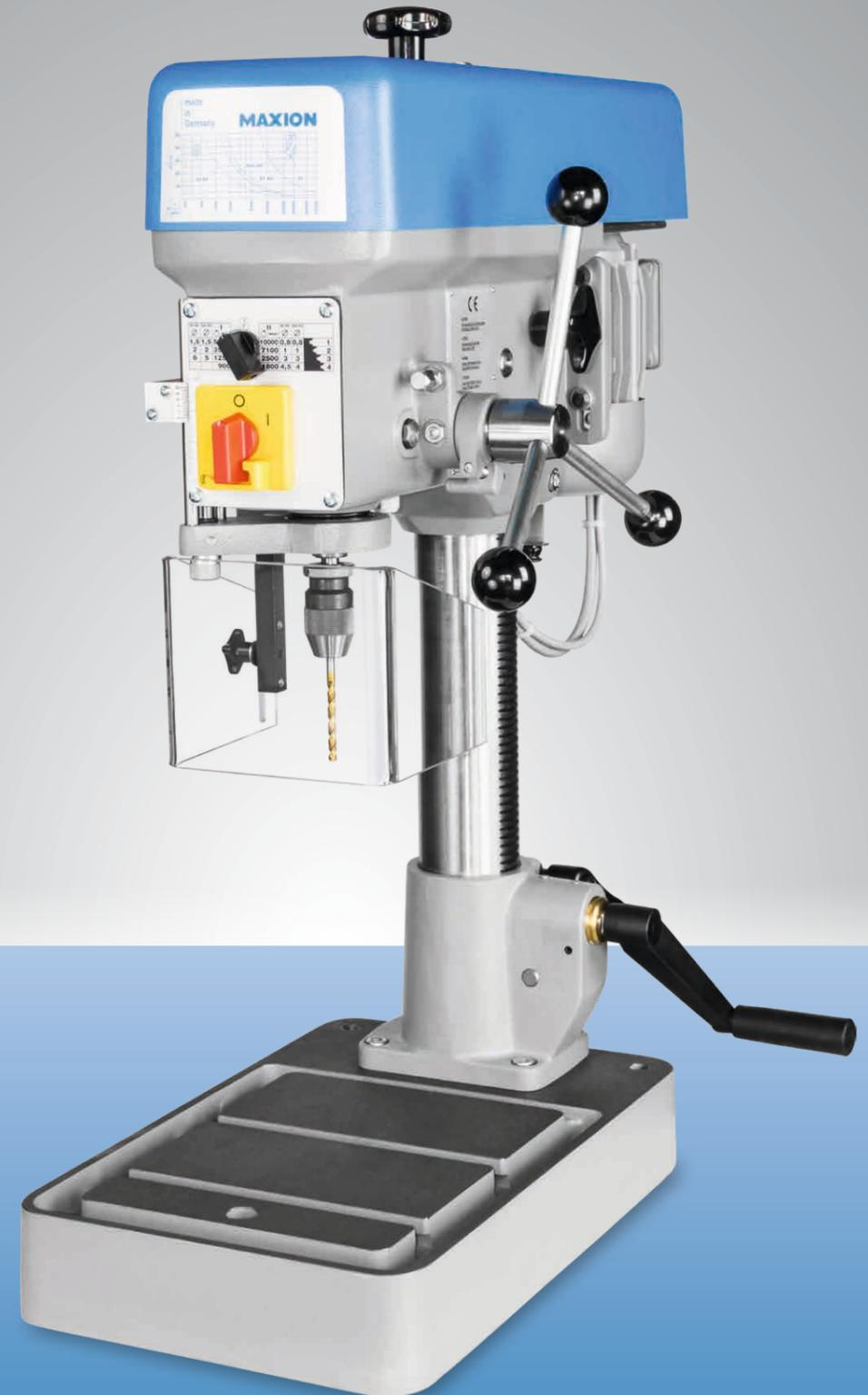
Станок изображен с опцией ограничение глубины сверления
