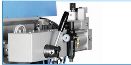
Гидро-пневматическое устройство подачи для полуавтоматического сверления до диаметра от 12 до 16 мм. Бесступенчатая регулировка подачи. Опционально функция задержки обратного хода при достижении установленной глубины сверления. Старт подачи осуществляется ножной педалью.
