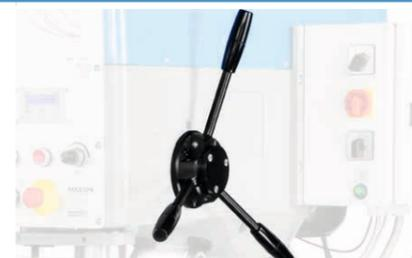
Подача включается и выключается легким нажатием одной из рукояток. На станках с нарезанием резьбы изменяется направление вращения.
